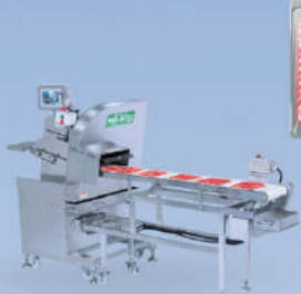
เครื่องสไลด์เนื้ออัตโนมัติ รุ่น NYL-165V2 อุณหภูมิเนื้อ -2 ถึง 2C
