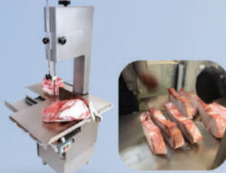
เครื่องเลื่อยเนื้อตัดกระดูก รุ่น ST-295AI มอเตอร์ 3 แรงม้า ใบเลื่อย 116"
