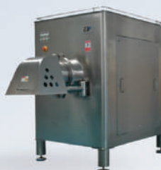
เครื่องบดเนื้อแช่แข็ง บดโครงไก่ รุ่น 1,000 และ 5,000 กก./ชม. Frozen Meat Grinder บดได้ถึง -18C
