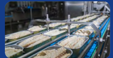
SEAMING, CRIMPING AND MARKING OF THE CANS JUTAGE, SERTISSAGE ET MARQUAGE DES BOÎTES
