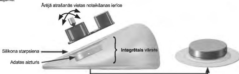
1. attēls. Audu expanderu ar integrēto vārstu ierīces shēma
