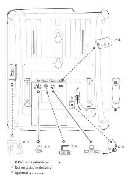
Como se puede ver en la imagen, este dispositivo puede ser alimentado a través de la red LAN mediante POE o a través de una fuente de alimentación compatible.
