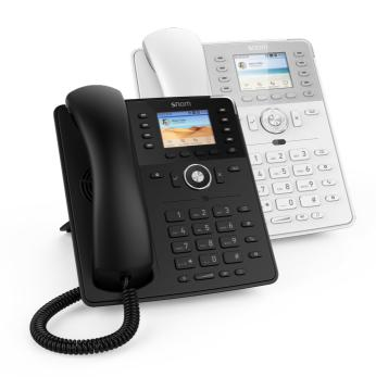
Este teléfono es un terminal de sobremesa premium, que permite configurar hasta 12 extensiones. Dispone de 8 botones de línea rodeando la pantalla y 4 teclas de función en la parte inferior.
