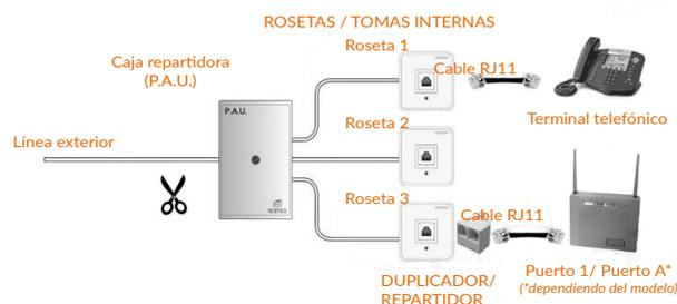
Vaya con mucho cuidado y asegúrese de estar cortando el cable de telefonía y no un cable de baja tensión o de otro tipo. Si la PAU se encuentra en el rellano, asegúrese de no cortar la línea de ningún vecino.
