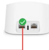
Conecta el equipo eero a tu router actual mediante cable ethernet a uno de los puertos de red del router y la alimentación de corriente de tu eero e instala la app de eero en tu dispositivo móvil (detalle en la página 8 de este manual).
