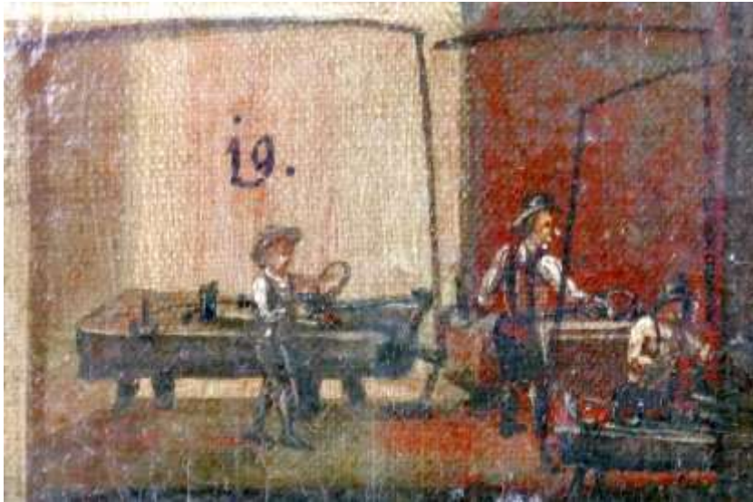
◀ Abb. $26$: Bildszene 19: Drahtzieherei mit massiven Ziehbänken. Die vertikalen Striche und horizontalen Bügel an der Decke lassen vermuten, dass die Ziehbänke mit Wasserkraft angetrieben wurden (analog Abb. $46$ und $76$). Diese Teile des Ölbildes sind durch den stark abgedunkelten Firnis beeinträchtigt. (Ausschnitt von Abb. $25$).
