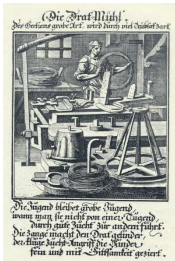
Abb. $46$: «Die Draht-Mühl» – Werkstatt zum Ziehen von dicken Drähten (vgl. Anm. 33). Man beachte den Mechanismus mit dem eisernen Greifgerät (Klauen-Drahtzange) auf der Werkbank vor dem Zieheisen (Bildmitte) und dem vom Untergeschoss über eine Bodenöffnung geführten Antrieb, der von einer elastischen Wippe (oben links) abgefedert wird. (nach Weigel 1698, 295–297)
