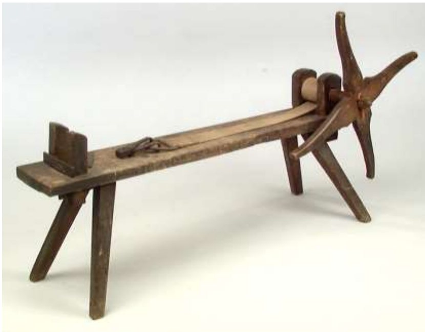
Abb. $157$: Hölzerne Drahtziehbank mit Haspel für Handbetrieb (rechts) und grosser eiserner Schleppzange (links) an einem stabilen Gewebeband. Das Zieheisen ist ganz links zwischen zwei Holzpflocken befestigt. Länge 205 cm, Höhe 110 cm. Angeblich aus einer Gold- und Silberschmiedewerkstatt, 18. Jahrhundert. (Foto Technisches Museum Wien/A, Inv.-Nr. 7565)
