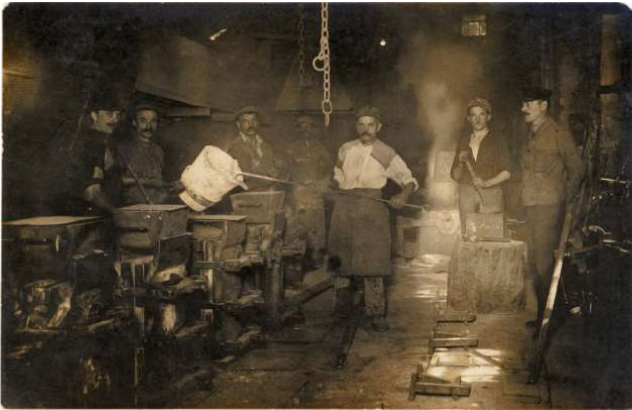
Abb. $131$: Die Giesserei im Messingwerk Reichraming. Foto um 1900, etwa zwei bis drei Jahrzehnte vor Aufgabe des Werkes. Vier Gussformen stehen links zum Eingiessen des Messings bereit. Ganz hinten rechts ist der rauchende Schmelzofen zu erkennen. Die Gusspeise ist im hoch gehaltenen schweren Tiegel bereit für den Guss. Die vier viereckigen Kästen mit Henkeln über den Formen sind vermutlich eine Art Trichter. Es ist zu vermuten, dass es sich bei den vertikal stehenden Formen um solche aus Gusseisen und nicht mehr um «Bretonische Steine» handelt [wie z. B. Abb. $89$; $101$]. Auf der Rückseite der Aufnahme sind mit Bleistift private «herzliche Grüsse aus Reichraming» eines Giessers an seinen Bruder und seine Schwägerin notiert. (Reproduktion Fotosammlung sagen.at, Wolfgang Morscher)
