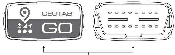
Antenne gps située au « bas » du dispositif.
