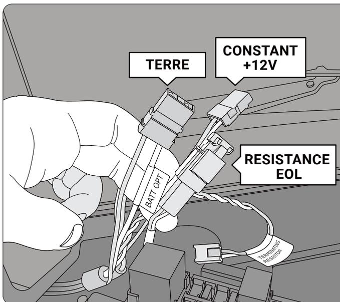
**ÉTAPE 2 :** À l'intérieur de la boîte à fusibles, repérez le connecteur étiqueté BATT OPT, et la résistance d'extrémité. Ils seront utilisés dans des étapes ultérieures.
