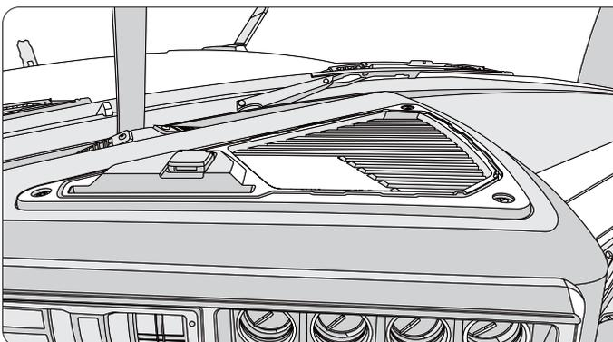
**ÉTAPE 8 :** Fixez le câblage à l'aide d'attaches mono-usage. Veillez à ne pas obstruer les fusibles. Effectuez une vérification de l'installation du dispositif GO, puis réinstallez le couvercle de la boîte à fusibles.
