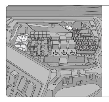
**ÉTAPE 5 :** Connectez le HRN-CM24Y1 au dispositif GO. Fixez le dispositif GO au faisceau à l'aide d'un collier de serrage en plastique. Fixez le dispositif GO au cadre de la boîte à fusibles à l'aide de deux colliers supplémentaires.
