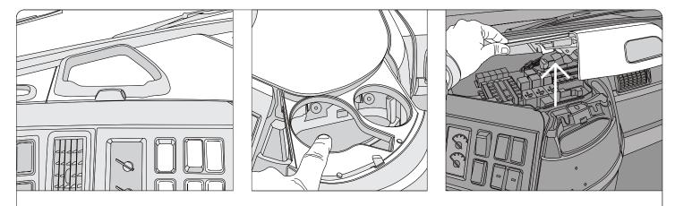
**ÉTAPE 1 :** Retirez les deux vis T-25 qui maintiennent le couvercle de la boîte à fusibles en place, puis tirez doucement vers le haut pour retirer le couvercle.
