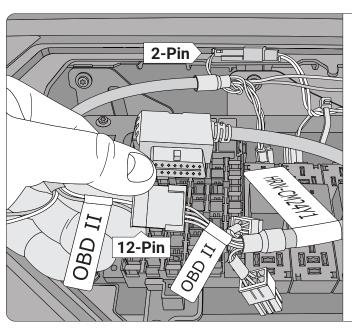
REMARQUE: Pour les modèles de véhicule Volvo des années 2004 à 2007, si le connecteur gris à 2 broches J1939 n'est pas disponible — branchez le connecteur noir à 2 broches du HRN-CE10K2 (fils vert et brun) dans le connecteur noir à 2 broches du coin passager supérieur de la boîte à fusible. Ensuite, branchez le connecteur noir à 12 broches Molex du HRN-CE10K2 au connecteur correspondant du HRN-CM24Y1. Ils sont tous deux étiquetés OBDII. connector on the HRN-CM24Y1. They are both labeled OBDII.
