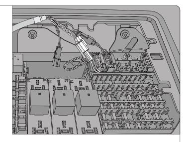
**ÉTAPE 4 :** Retirez la résistance terminale et branchez-la à l'extrémité de jumelage du HRN-CE10K2. Branchez le HRN-CE10K2 à l'endroit d'où la résistance terminale a été retirée.
