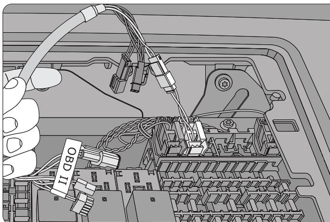
**PASO 3:** Conecte el otro extremo del conector al conector negro de 2 pines del HRN-CE10K2.
