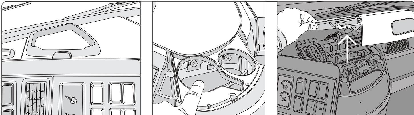
**PASO 1:** Retire los dos tornillos T-25 que sujetan la cubierta de la caja de fusibles en su lugar y, luego, tire suavemente hacia arriba para quitar la cubierta.
