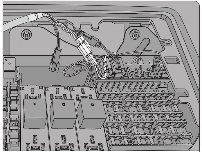
**PASO 4:** Quite la resistencia terminal y, luego, conéctela en el extremo de contacto del HRN-CE10K2.
