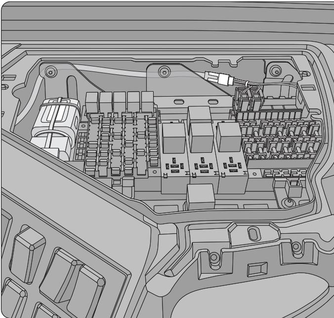
**PASO 5:** Conecte el HRN-CM24Y1 al dispositivo GO. Asegure el dispositivo GO al arnés con una abrazadera plástica. Asegure el dispositivo GO al marco de la caja de fusibles con dos abrazaderas plásticas adicionales.
