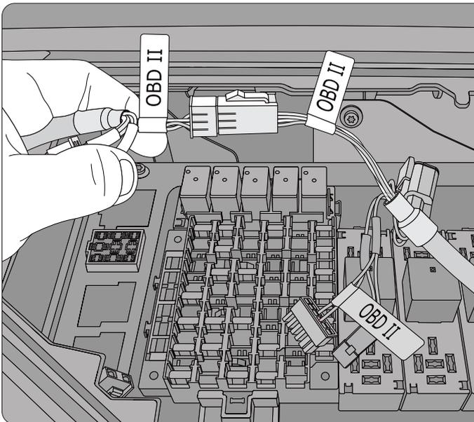
**NOTA:** Para los modelos de vehículos Volvo 2008 y posteriores en los que el conector J1939 gris de 2 clavijas está disponible: conecte el conector Molex blanco de 6 pines del HRN-CE10K2 al conector Molex blanco de 6 pines del HRN-CM24Y1. Ambos están etiquetados como OBDII.
