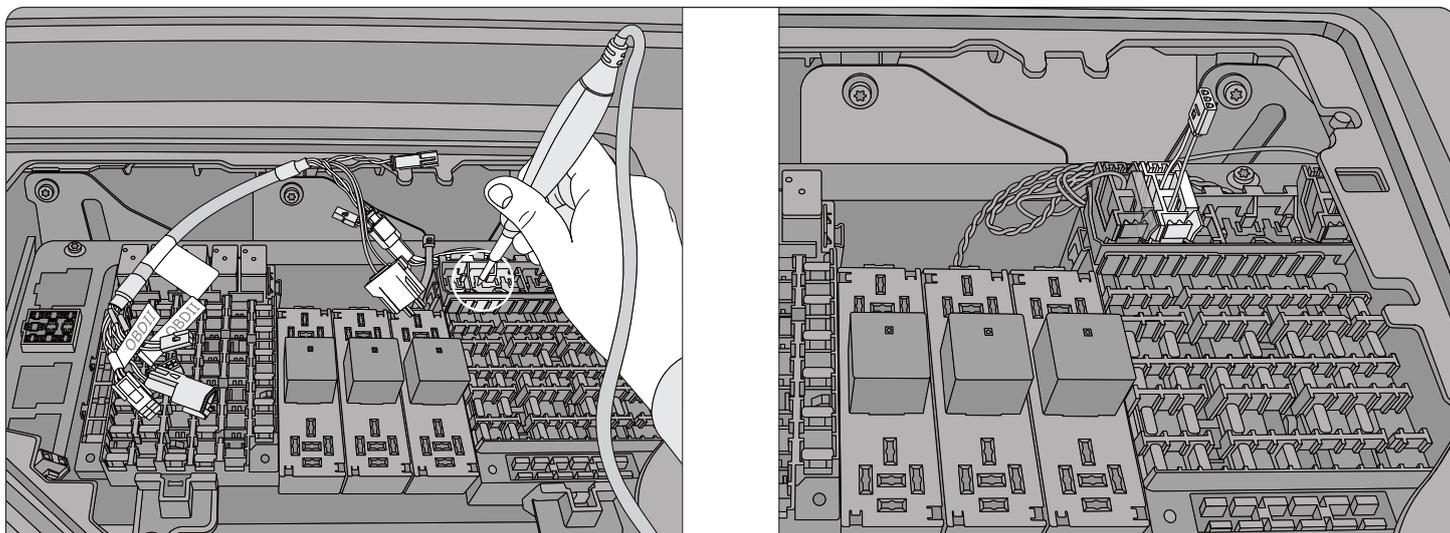
**PASO 2:** Conecte el conector blanco de 2 pines del kit en cualquier ranura de alimentación constante de repuesto.
