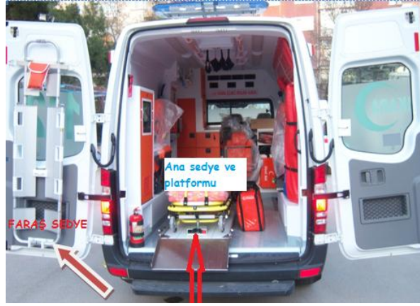
Resim 1.10: Ana sedye ve faraş sedyenin ambulans içindeki konumu
