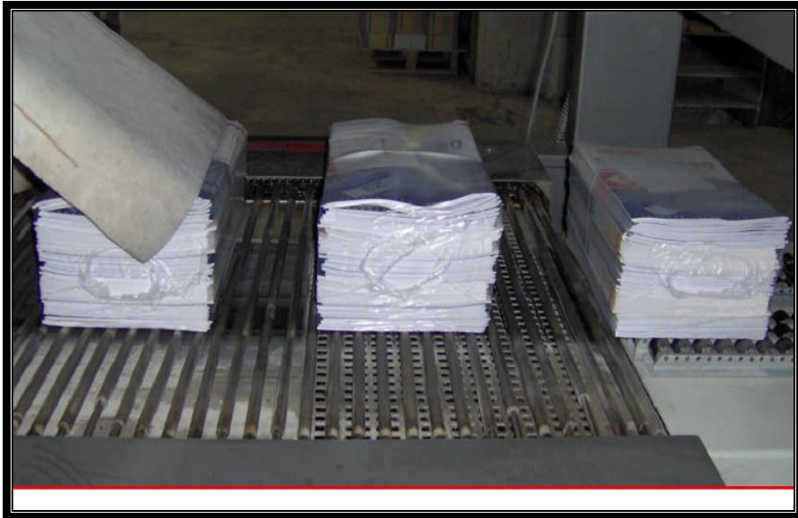
Resim 1.9: Folyolanmış ürünlerin makineden çıkışı
