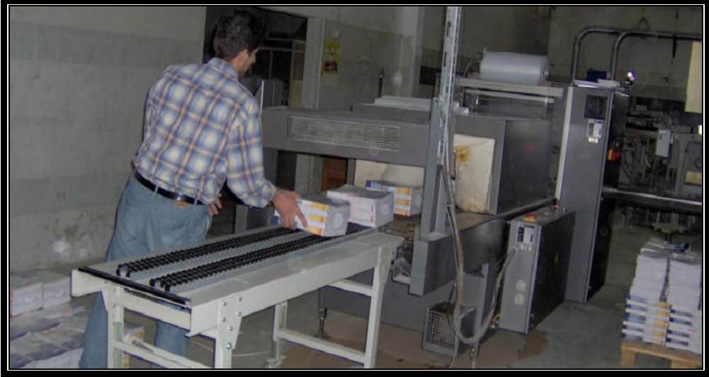
Resim 1.8: Basılan ürünlerin folyolama makinesine yerleştirilmesi
