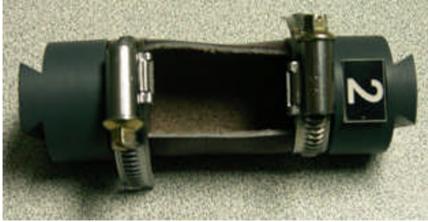
Resim 5.2: Silindirlere takılmış test parçası
