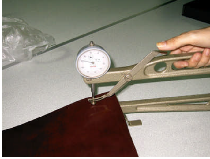
Resim 2.1: Basit Bir kalınlık ölçer ile deri kalınlığının ölçülmesi
