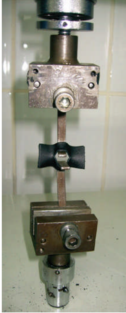
Resim 4.1: Test parçası ve metal tutucular
