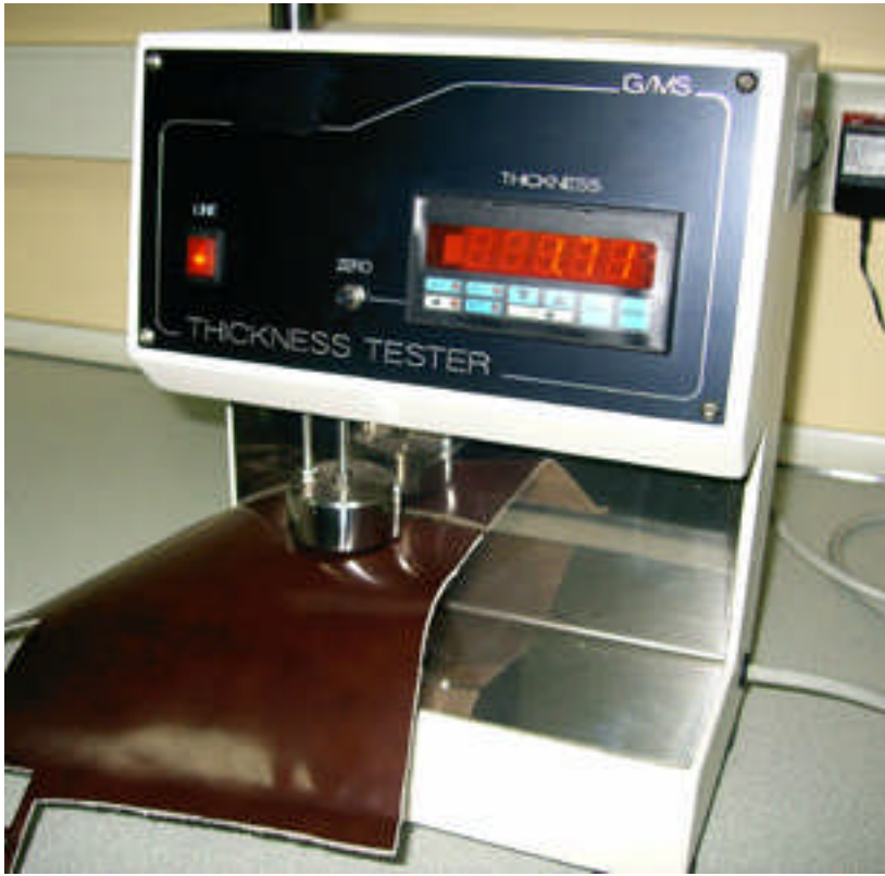
Resim 2.3: Dijital kalınlık ölçerle deri kalınlığının ölçülmesi
