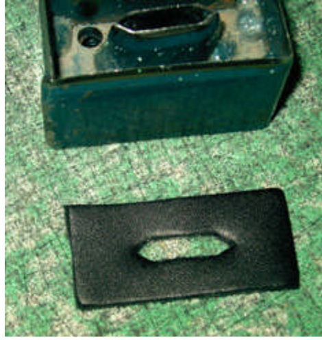
Resim 4. 2: Test parçası ve kesim bıçağı
