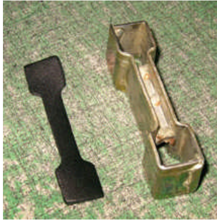
Resim 3. 2: Test parçası ve kesim bıçağı
