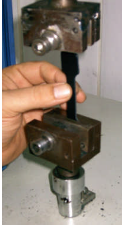
Resim 3. 3: Test parçasının cihaza bağlanması
