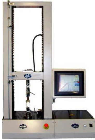
Resim 3.1: Kopma deney cihazı
