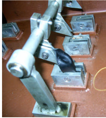
Resim 6. 2: Fleksometre cihazında test parçası
