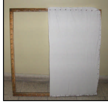
Resim 1.16: Germe işleminin tamamlanması
