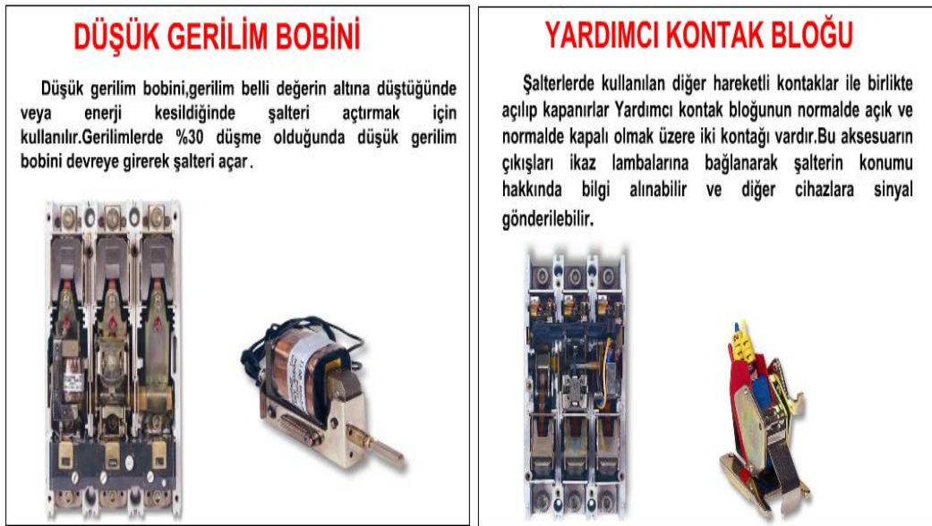
Resim 1.11: Devre kesicisi ilave düşük gerilim bobini ve yardımcı kontak bloğu
