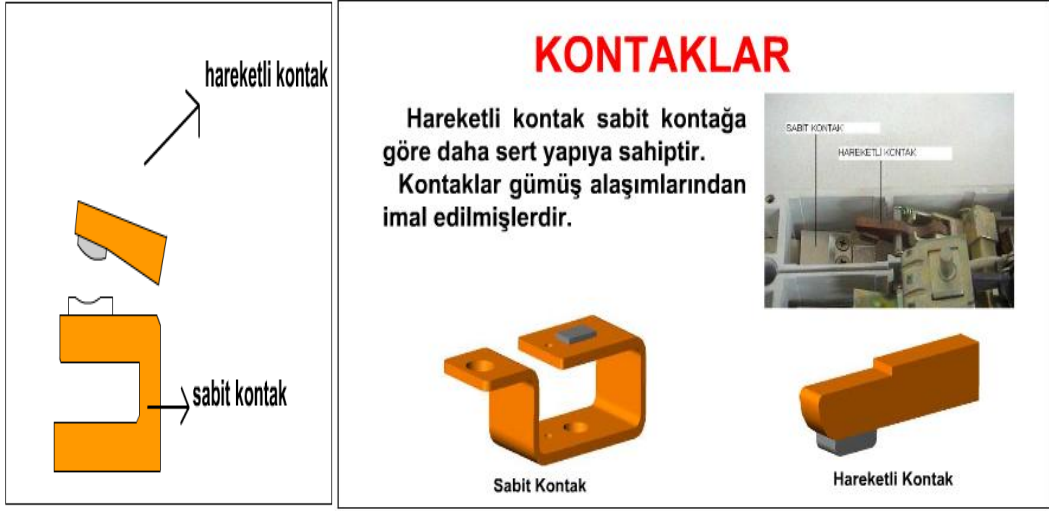
Şekil 1.13: Kesicilerde kontaklar
