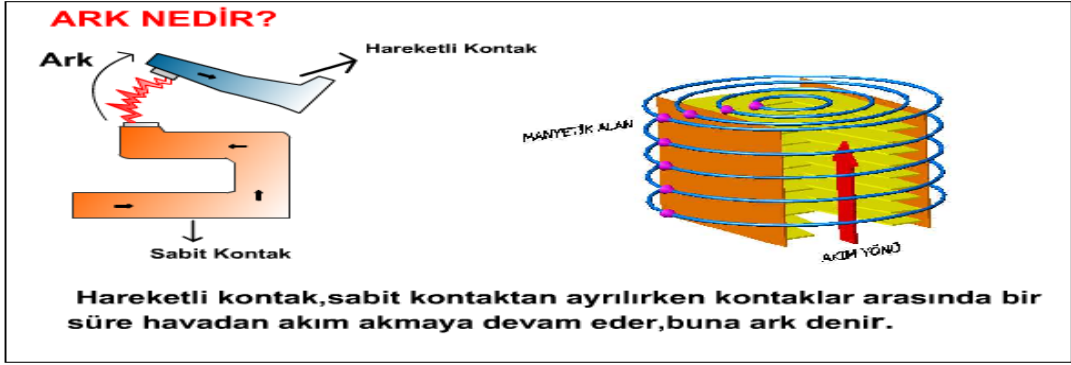
Şekil 1.14: Devre kesici kontaklarında ark oluşumu
