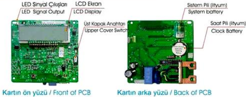
Resim 1.13: Elektronik sayaç iç yapısı
