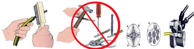
Şekil 4.3: Kablo yalıtkanının soyulmasında dikkat edilecekler
