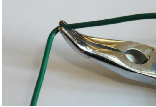
Resim 1.13: Kargaburnu ile iletkenin bükülmesi
