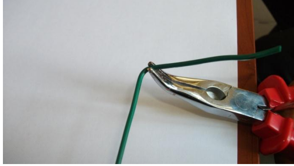
İletkenin kargaburnu ile bükülmesi
