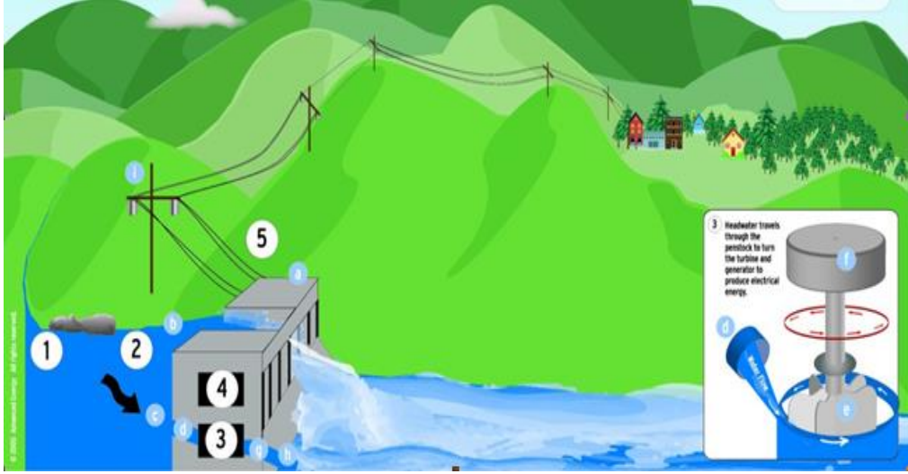
Şekil 1.26: Depo tipi (barajlı) hidroelektrik santral prensibi
