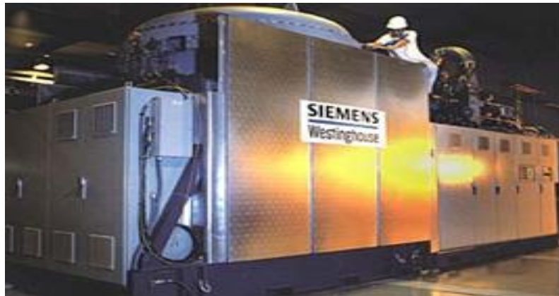
Resim 1.8: 250 kW'lık gaz türbinli, yakıt hücreli bir birleşik elektrik ve ısı üretimi sistemi
