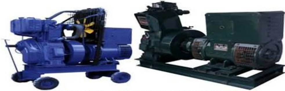
Resim 1.15: Küçük güçlü (7.5 KVA 'lık) jeneratör setleri
