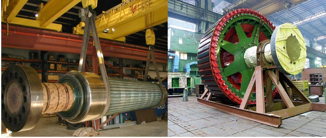
Resim 2.1: Sırasıyla çıkık kutuplu ve silindirik (düz) kutuplu senkron makine rotorları
