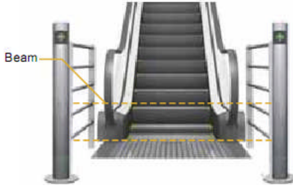
Resim 1.6: Yürüyen merdivenlerde optik sensörlerin konumlandırılması
