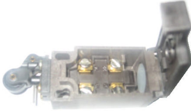
Resim 1.3: Yürüyen merdivenlerde kullanılan bir sınırlama anahtarının açılmış hâli
