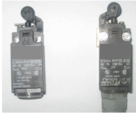
Resim 1.2: Yürüyen merdivenlerde kullanılan sınır anahtarları
