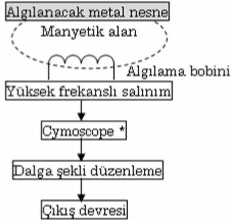
Şekil 1.8: Endüktif sensör blok diyagramı
