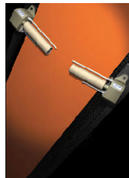
Şekil 1.3: Mekanik kenar sensörlü pnömatik kontrollü kenar açıcı (Tekstil sektörü)
