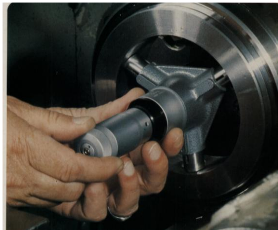
Resim 4.10: İç Ölçü Mikrometresi ve Kullanılması
