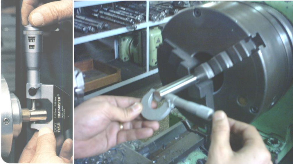
Resim 4.8: Torna Tezgahında Mikrometre İle Dış Çap Ölçümü
