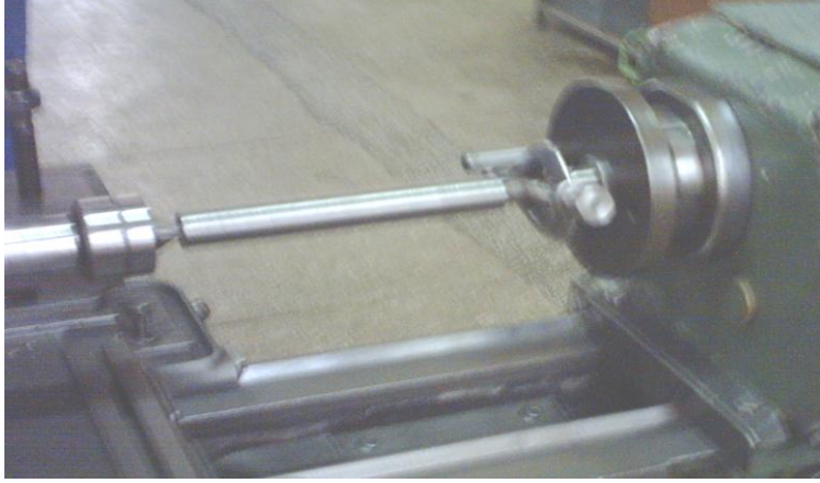
Resim 7.2: İş Parçasını Firdöndü Aynası İle İki Punta Arasında Bağlama
