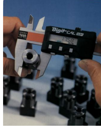
Şekil 4.3: Kumpas İle Dış Ölçüm Yapılması Resim 4.4: Dijital Kumpasla Dış Ölçüm Yapılması
