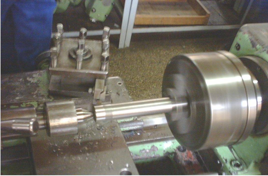
Resim 7.3:Torna Tezgahında Silindirik Dış Yüzey Tornalama
