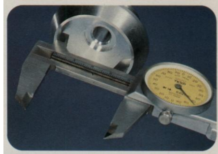
Şekil 4.4: Kumpas İle Deliklerin Ölçülmesi Resim 4.5: Kumpas İle Deliklerin Ölçülmesi
