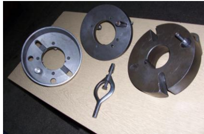
Resim 3.5: Fırdöndü Aynaları ve Fırdöndü
