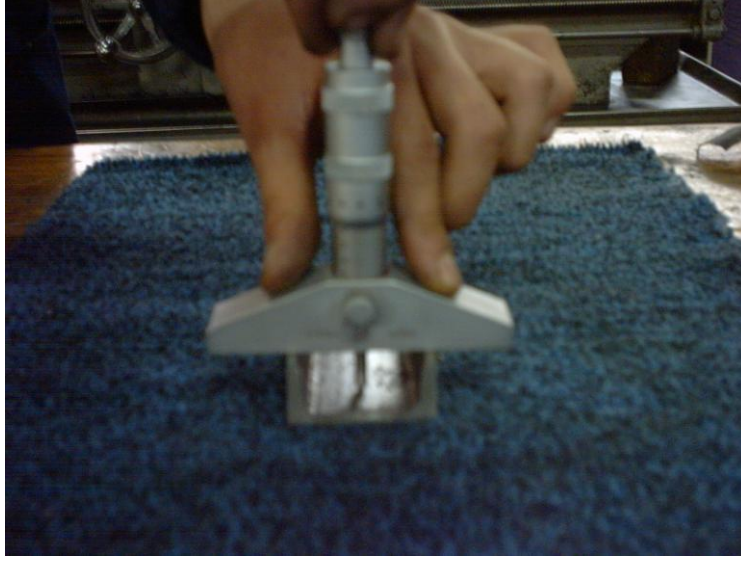
Resim 4.11: Derinlik Mikrometresinin Kullanılışı
