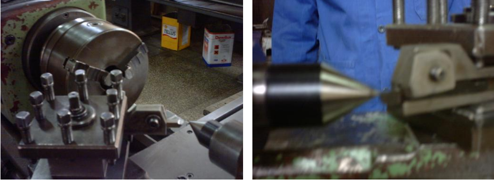
Resim 2.8: Kalemın Punta Yüksekliğinde Bağlanması
