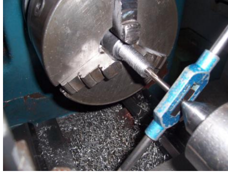
Resim4.4: Kılavuzun Parçaya Ağızlatılması
