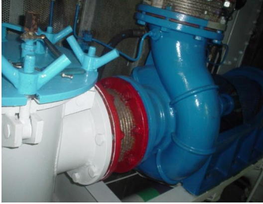
Resim 2.4: Balast pompası alıcı hattında bulunan kompensatör
