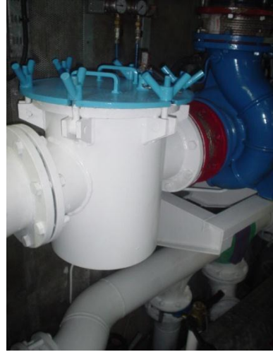
Resim 2.3: Balast pompası alıcı hattında bulunan çamur sandığı
