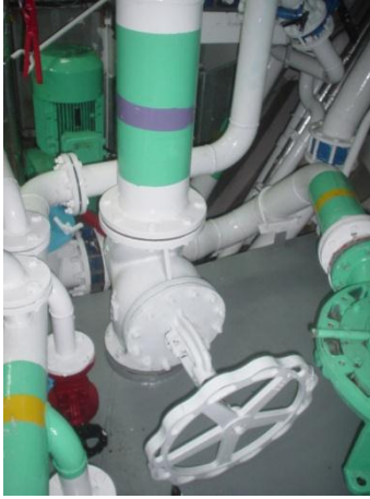
Resim 2.9: Deniz suyunun geri döndürmez globe vanalar ile deniz sandığından dışarı atılması
