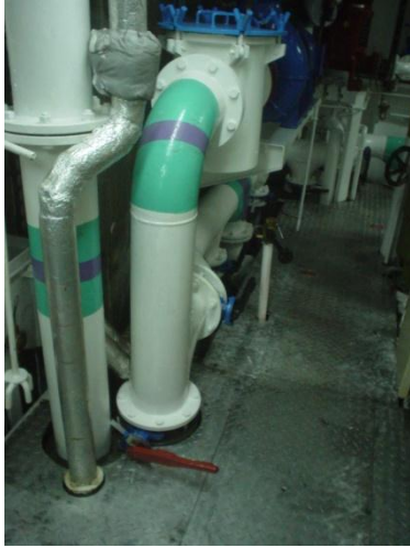
Resim 2.3: Balast pompası alıcı hattında bulunan çamur sandığı
