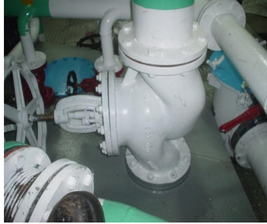
Resim 2.9: Deniz suyunun geri döndürmez globe vanalar ile deniz sandığından dışarı atılması
