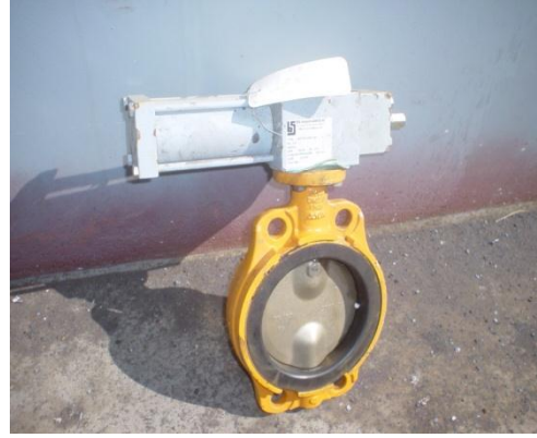
Resim 2.8: Uzaktan kumandalı pnömatik vana
