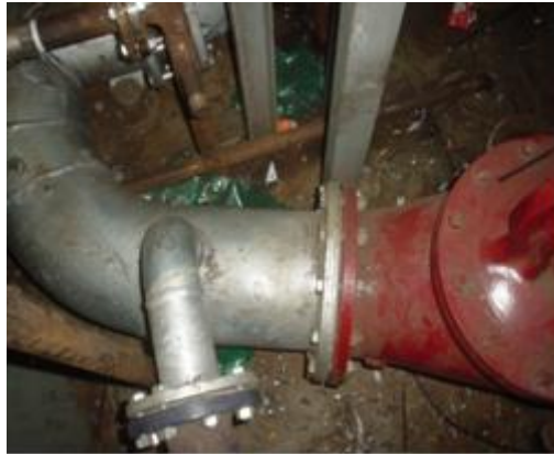
Resim 2.1: Deniz sandıkları arası ana deniz suyu hattı ve alıcı vana
