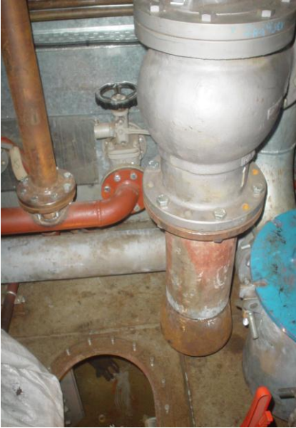
Resim 1.1: Makine dairesi sintinesini emen gönye vana
