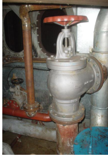
Resim 1.1: Makine dairesi sintinesini emen gönye vana
