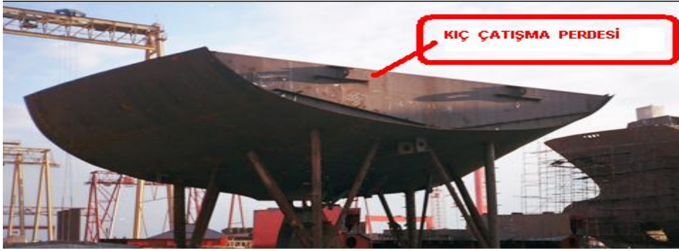
Resim 4.1: Kıç çatışma perdelerin ön imalat aşaması
