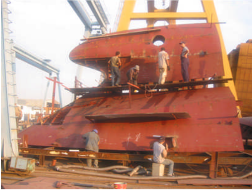
Resim 1.8: Ters olarak inşa edilen blok
