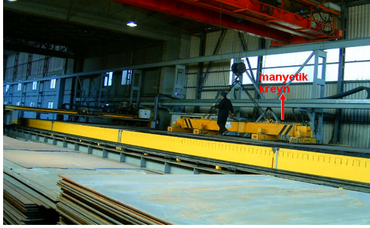
Resim 1.2: Manyetik kreyin ile sac plaka taşınırken
