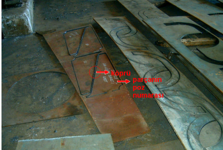
Resim 1.4: Kesilen parçalar ve aralarındaki köprü
