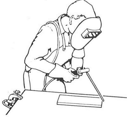
Şekil 2.14. Yatay konumda kaynakçının duruşu
