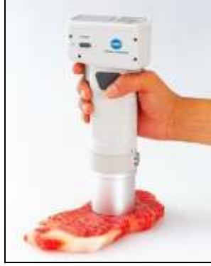
Resim 2.6: Kırmızı ette cihazla renk ölçümü
