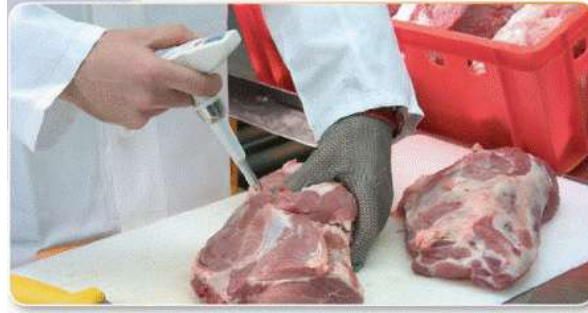
Resim 2.4: Kırmızı ette portatif pH metre ile pH ölçümü
