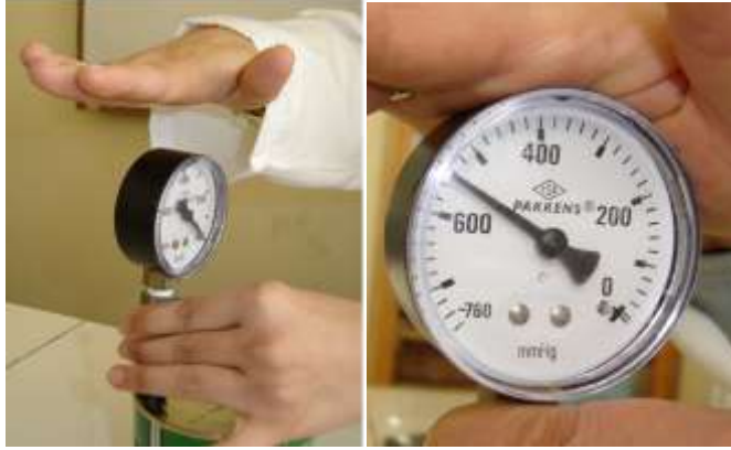
Resim11.3: Konserve kutusunda vakum metre ile vakum ölçölmesi
