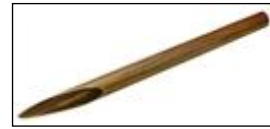
Resim 1.1: Standart bölmeli numune ve çuval sondası
