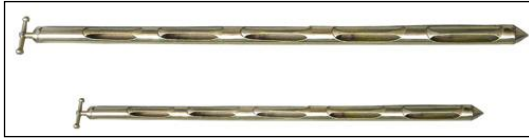
Resim 1.1: Standart bölmeli numune ve çuval sondası
