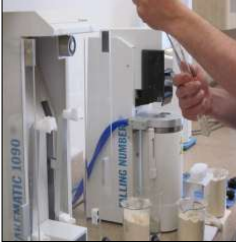
Resim 3.10: Vizkometre karıştırıcısını tüpe yerleştirme Resim 3.11:Tüpleri cihaza yerleştirme
