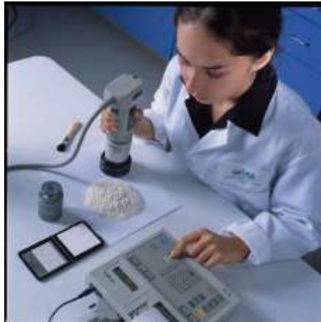
Resim 1.4: Lovibond tintometresi ile unda renk tayini
