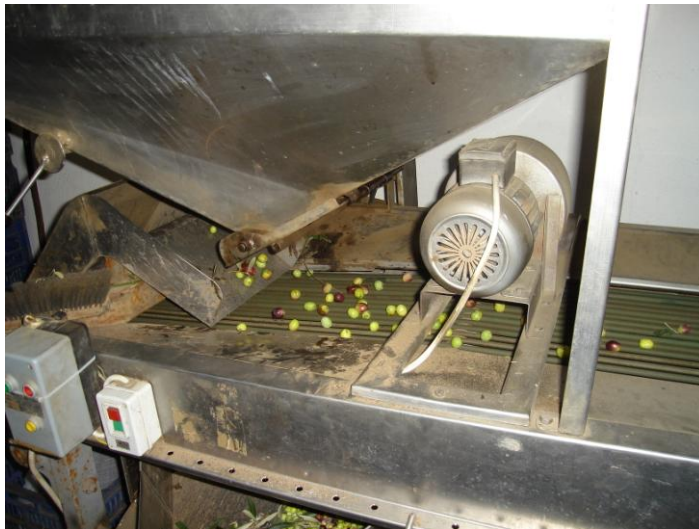
Resim 2.4: Zeytinlerin bunkerden iplere geçişi
