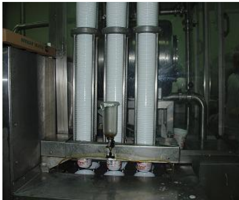
Resim 3.13: 300 g'lık hazır ambalajların makineye yerleŐtirilmesi
