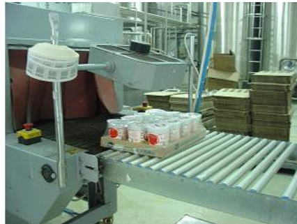
Resim 3.23: Otomatik olarak şrinkleme (karton viyol)-Aşama 3
