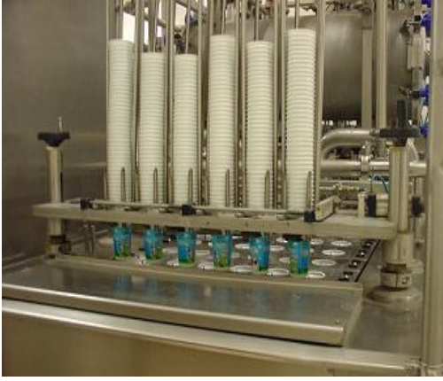
Resim 3.11: 200 g'lık hazır ambalajların makineye yerleŐtirilmesi
