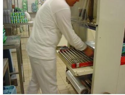
Resim 3.20: Yarı-manuel olarak şrinkleme (plastik viyol) –Aşama 2
