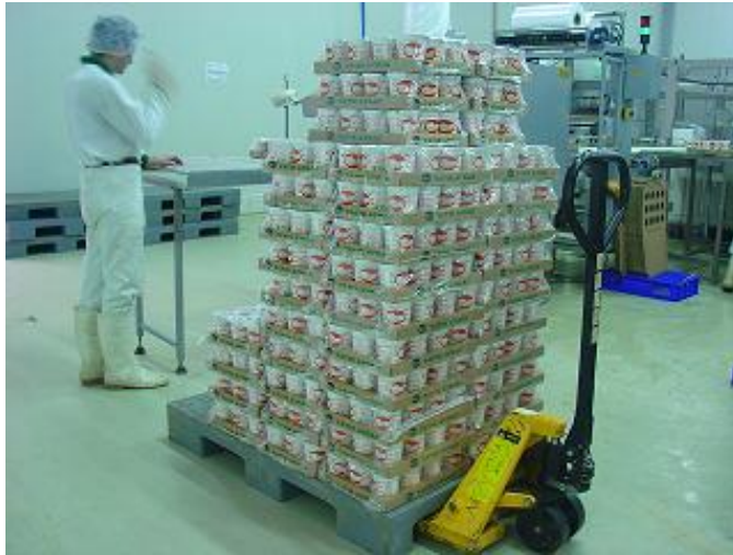
Resim 3.26: Palet üzerine dizilmiş ayran kolilerinin palet taşıyıcı ile taşınması
