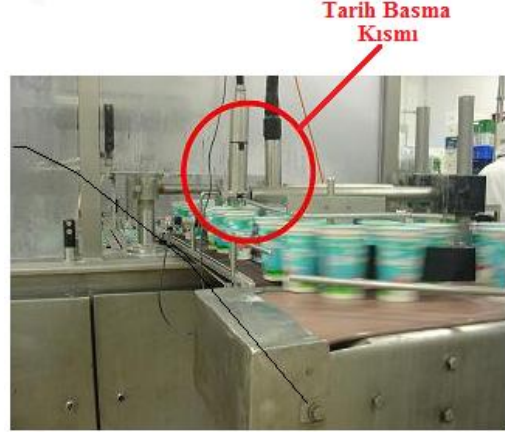
Resim 3.16: Kapakları kapatılmış ambalajlara tarih basılması
