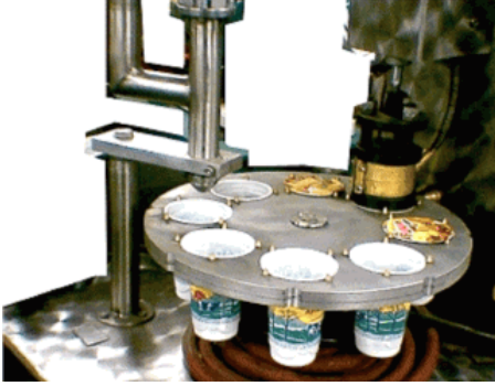
Resim 3.15: Dolumu yapılmış ayran ambalajlarının kapatılması
