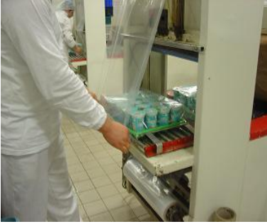
Resim 3.19: Yarı-manuel olarak şrinkleme (plastik viyol)-Aşama 1
