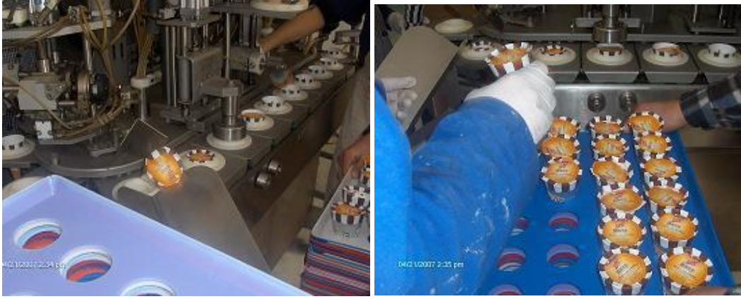
Resim 3.8: Kornet ambalajlanması ve özel plastik kasalara yerleştirilmesi
