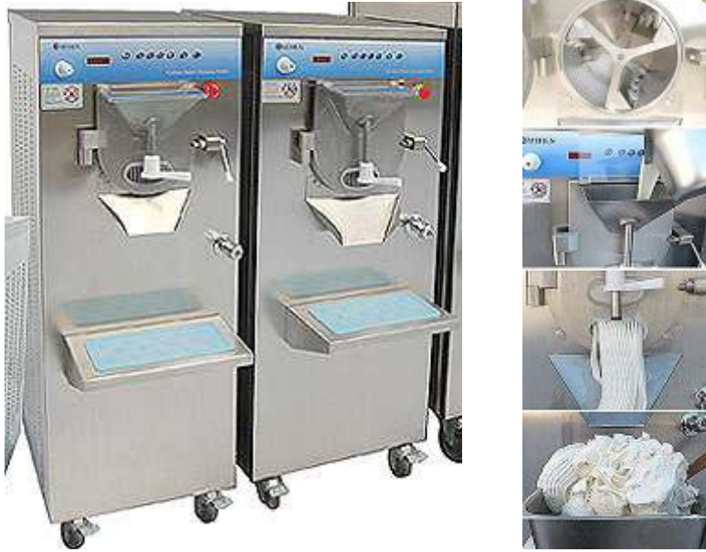
Resim 2.6: Kesikli dondurucu ve dondurma işlemi
