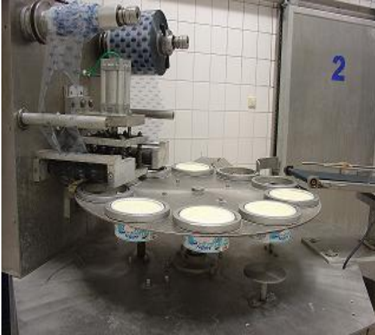
Resim 2.17: Dolumu yapılmış yoğurt ambalajlarının otomatik sistemde kapatılması
