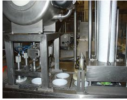
Resim 2.16: Makinelerle hazır yoğurt ambalajlarına dolum
