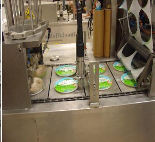
Resim 2.17: Dolumu yapılmış yoğurt ambalajlarının otomatik sistemde kapatılması
