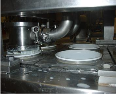
Resim 2.16: Makinelerle hazır yoğurt ambalajlarına dolum
