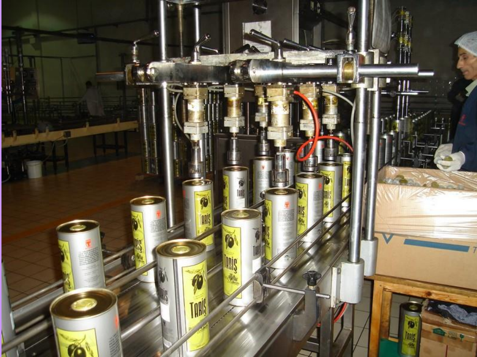
Resim 2.11: Teneke dolum makinesinin kapak kapatma ünitesi
