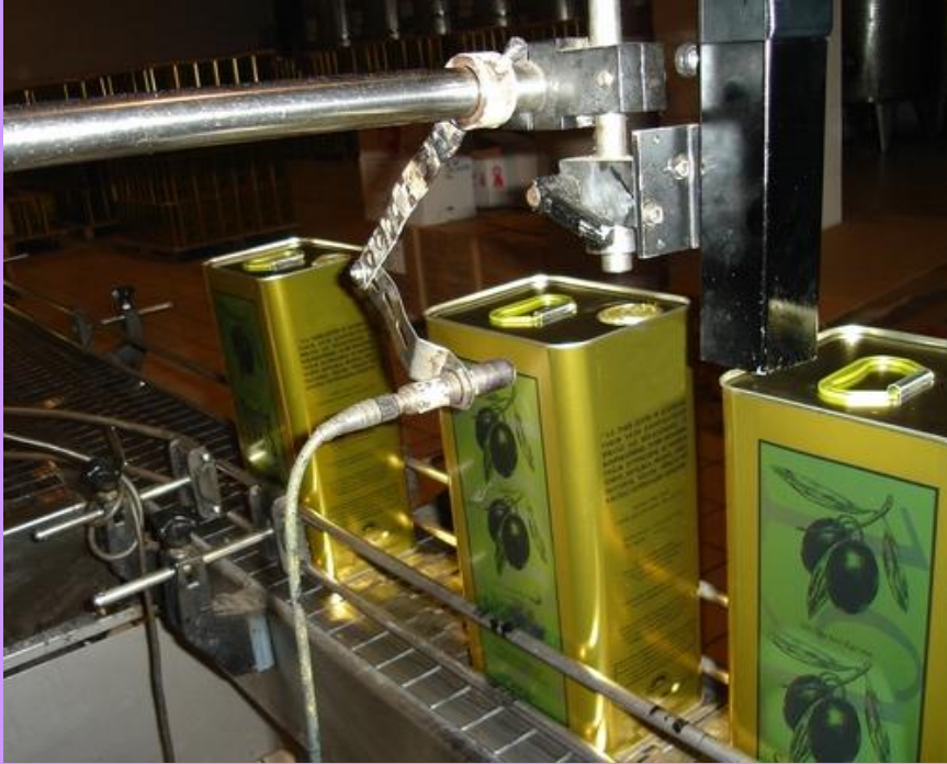
Resim 3.2: Kodlama makinesi ile teneke kutu üzerine üretim, son kullanma tarihleri ve üretim seri numarası basılması
