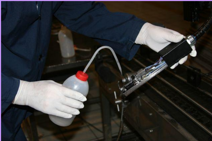
Resim 3.5: Yazma kafasının solvent ile temizliđi
