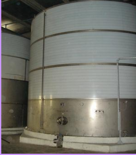
Resim 1.3: Isıtma ceketlerine sahip dinlendirme tankı
