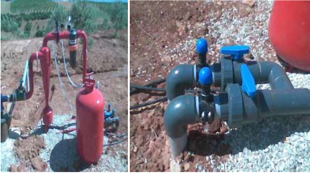
Fotoğraf 2.8: Zeytinde damla sulamada kullanılan gübreleme tankı ve dağıtımı
