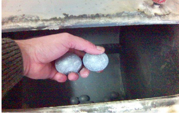
Resim 2.18: Bilyelerin tambura konulması
