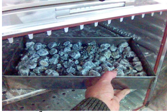
Resim 2.31: Elek Üzerinde yıkanan numunenin etüve konulması
