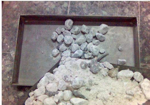
Resim 2.27: Aşınmış numunenin metal kap içine konulması
