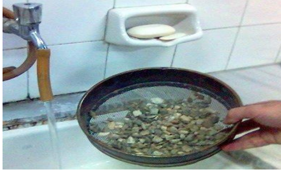
Resim 2.15: Agreganın 12 nu.lı elek üzerinde yıkanması
