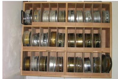
Resim 3.5: Elek serilerinin dizilmesi
