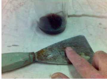
Resim 3.60: Spatulanın aşınmış metal yüzeyinin yağlanması
