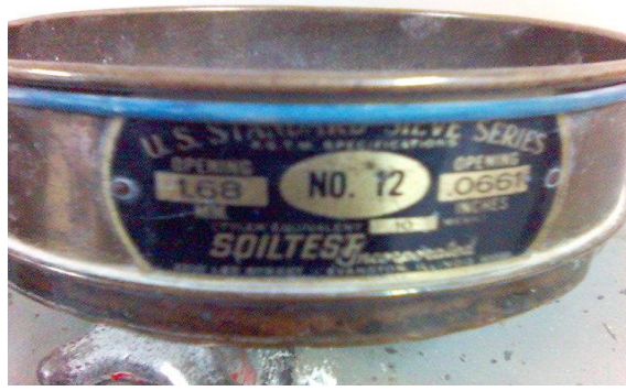
Resim 2.29: Aşınmış numuneyi yıkamak ve elemek için kullanılan 12 nu.lı elek
