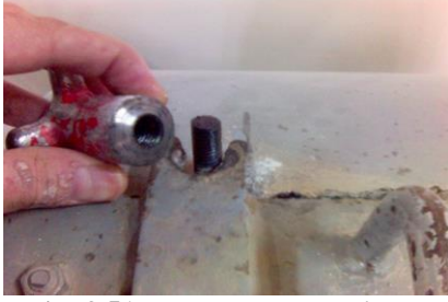
Resim 3.51: Tambur kapak vidalarını yağlama
