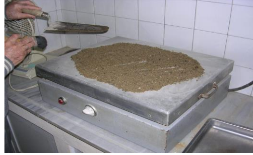
Resim 1.12: Numunenin yüzeyinin kurutulması
