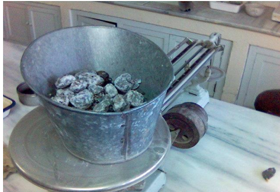
Resim 2.33: Etüv sonrası soğutulmuş numunenin tartılması
