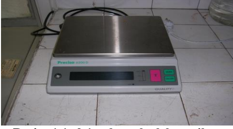
Resim 1.1: 0,1 g duyarlı elektronik terazi
