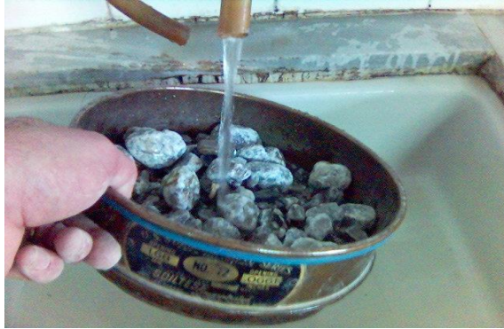
Resim 2.30: Aşınmış numunenin 12 nu.lı elekten geçirilerek yıkılması
