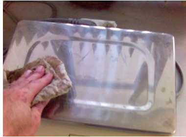
Resim 3.44: Hassas terazini silinmesi
