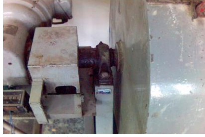
Resim 3.52: Tambur yataklarını yağlama
