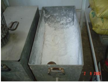
Resim 3.56: Sülfat tuzunun kapaklı ve galvanizli sandıklarda korunması
