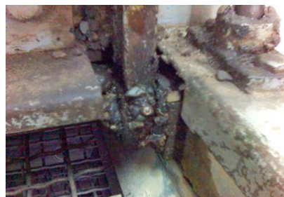
Resim 3.50: Çakıl elek sarsma aletinin rulmanlarını yağlama
