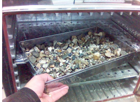
Resim 2.16: Yıkanmış agreganın etüve konulması
