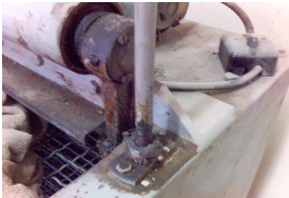
Resim 3.49: Çakıl elek sarsma aletinin kollarını yağlama
