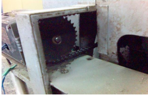
Resim 3.53: Losangeles aletinin numaratör dişlisini yağlama
