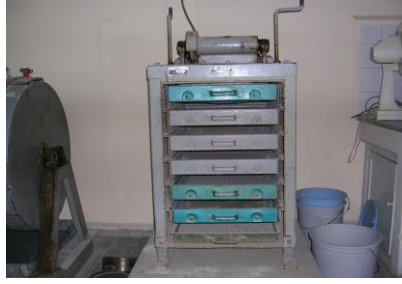
Resim 3.6: Çakıl elek sarma makinesinin eleklerinin yerine konması
