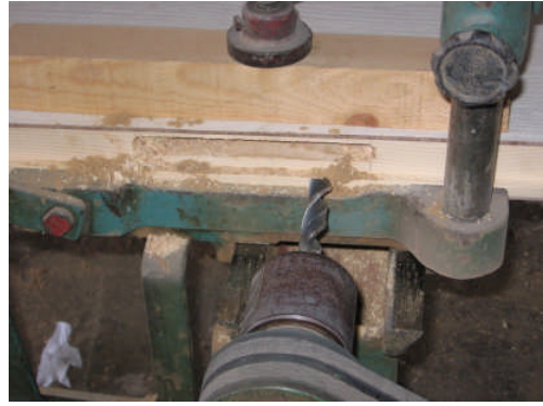
Resim 1.28: Kilit yuvasının yatay delik makinesinde delinmesi
