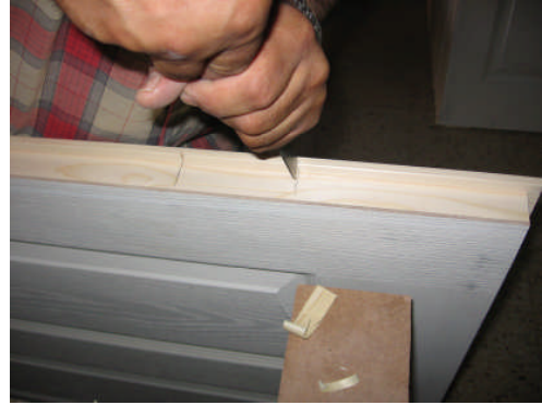
Resim 1.21: Menteşe yeri boşaltma sınırının oluşturulması
