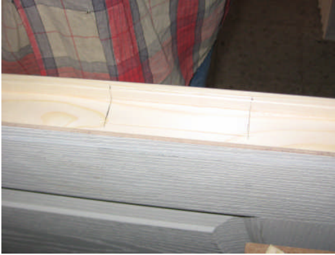
Resim 1.21: Menteşe yeri boşaltma sınırının oluşturulması
