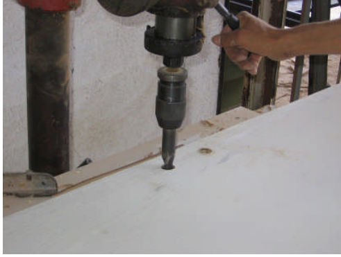
Resim 1.29: Kol deliklerinin dikey delik makinesinde delinmesi
