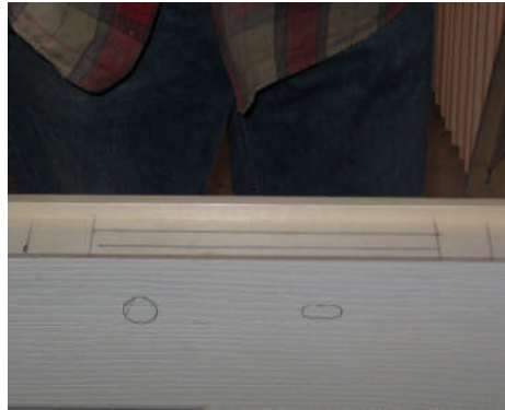
Resim 1.27: Kilit ve kol yeri markalanmış kanat
