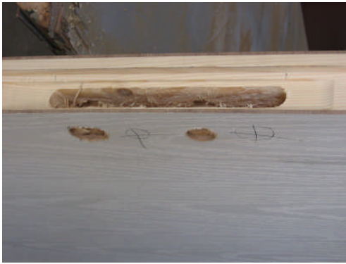
Resim 1.30 a,b,c,d,e,f: Kilit lamasının markalanması ve lama yerinin iskarpela ile boşaltılması
