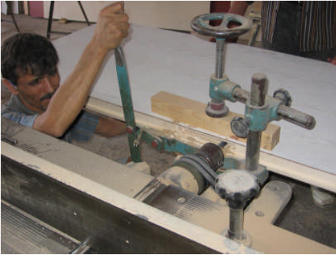
Resim 1.28: Kilit yuvasının yatay delik makinesinde delinmesi
