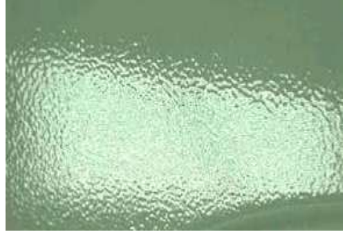
Şekil 1.1: Portakal kabuğu görüntüsüne sahip yüzeyden ışığın yansıması ve portakal kabuğu görüntüsüne sahip bir yüzey örneği
