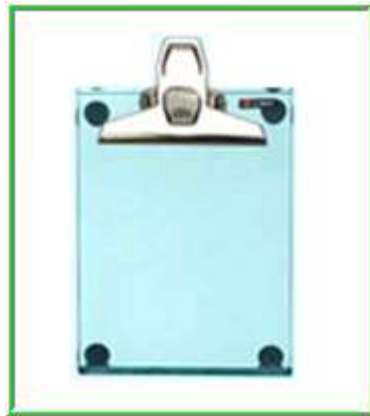
Resim 1.3: Cam test plakası
