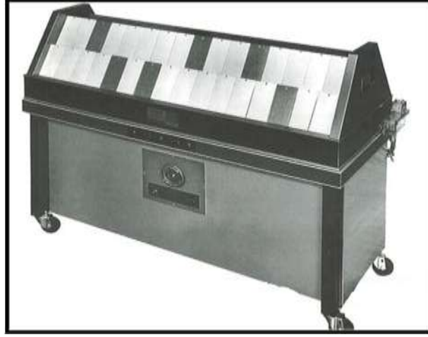
Resim 4.4: Yoğuşmalı nem kabini
