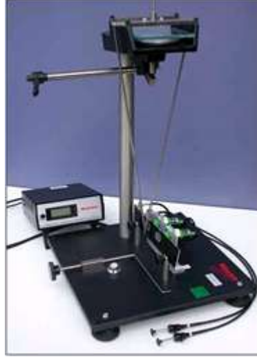
Resim 1.8: Sertlik ölçümü ve Koing Albert sarkacı
