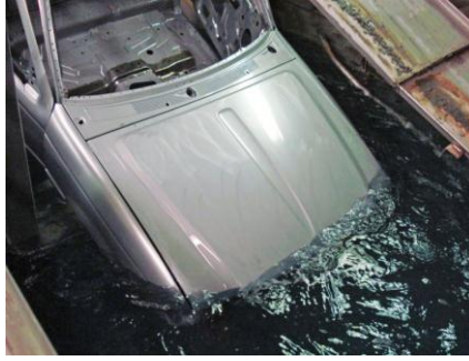
Resim 1.3: Fosfatlama havuzuna batırılan metalik yüzey
