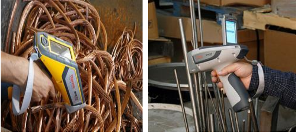
Resim1.15: Portatif XRF cihazları ile malzeme kontrolü
