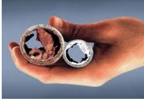
Resim 4.1: Sert suyun borularda meydana getirdiği kireç tabakası
