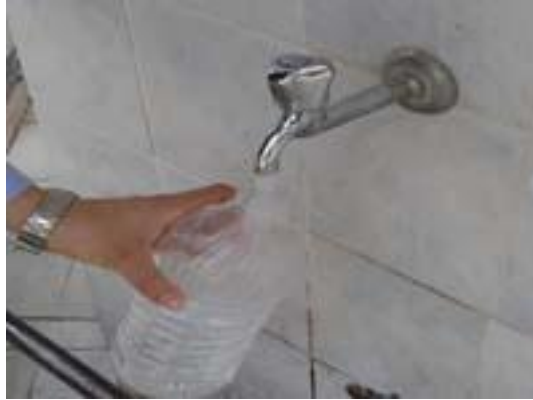
Resim 1.4: Çeşme suyundan numune alma
