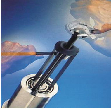
Yataklardan iç çekirme ile rulman sökümü
