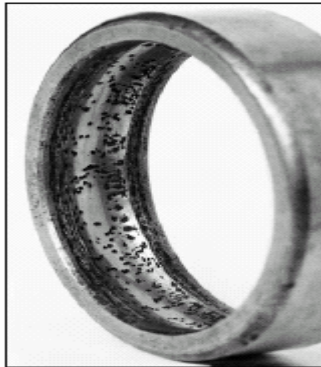
Şekil 1.3: Dış bilezikte nemden kaynaklanan korozyon örneği
