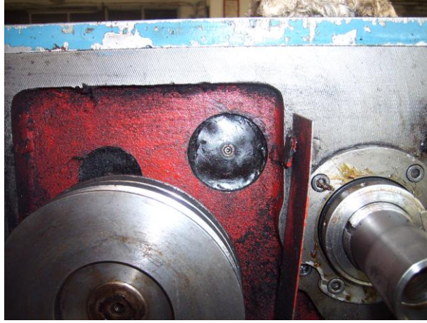
Resim 2.2: Rulman kapağının takılması
