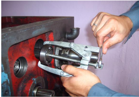
Resim 1.5: Çekirtilme vidasıyla rulmanın milden çıkarılması
