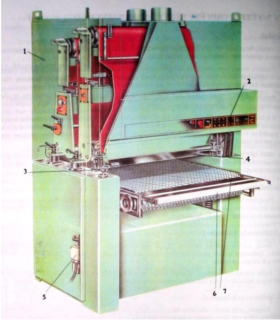
1 – Gvde 2 – Kumanda tablosu 3 – Kalınlık ayarı 4 – Emniyet laması 5 – Reglatr 6 – Silindir 7 – Bant
