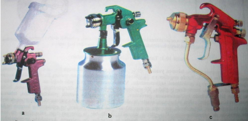
a) Üstten depolu boyama tabancası (sis tabancası) b) Alttan depolu boyama ve vernik tabancası c) Basınçlı sıvı kazanı ile çift hortumlu boyama ve vernik tabancası
