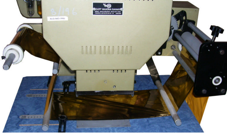
Resim 3.1: Bobinin makineye takılması
