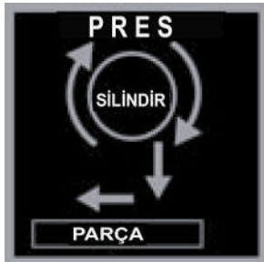
Resim 1.13: Silindirik kalıpla düz yüzeylere baskı yapan pres
