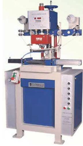
Resim 1.14: Düz kalıpla silindirik yüzeylere baskı yapan pres
