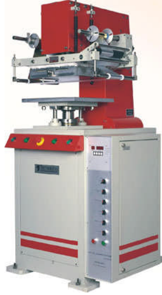
Resim 1.12: Düz kalıpla düz yüzeylere baskı yapan pres
