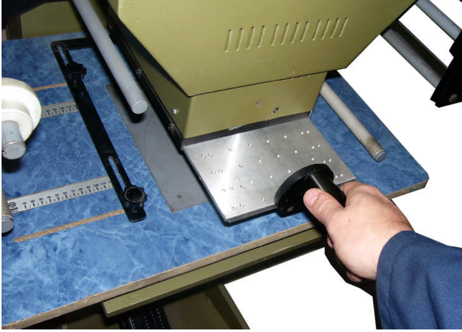
Resim 1.22: Klişer altlığının makineden çıkarılması
