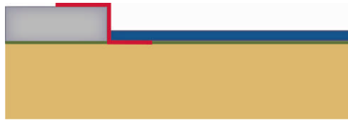
Şekil 2.4: Poza altına kaçmanın önlenmesi
