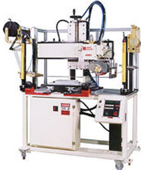
Resim 1.13: Silindirik kalıpla düz yüzeylere baskı yapan pres
