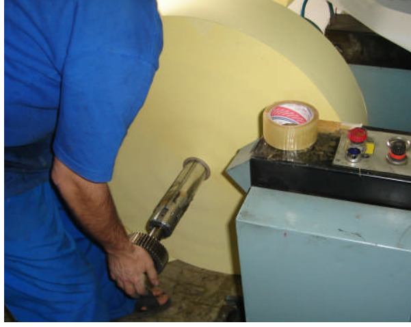
Resim 2. 1: Bobinin Makineye Yüklmesi
