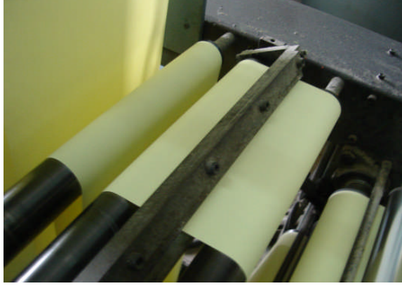
Resim 2. 3: Bobinin makinenin merdaneleri arasından geçmesi.
