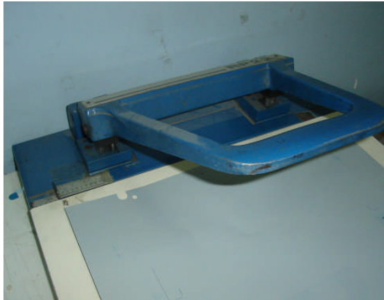
Resim 2. 9. : Sürekli Form Baskıda Kalıba Delik Açma Tezgahı
