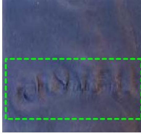
Resim 2.6: Gerilim hatasının kumaş yüzeyindeki görünümü
