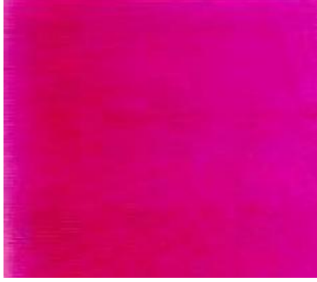
Resim 2.8: Düzgünsüz boyama hatasının kumaş yüzeyindeki görünümü
