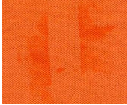
Resim 2.9: Kostik lekesi hatasının kumaş yüzeyindeki görünümü
