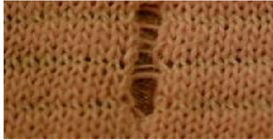
Resim 1.20: Kırık iğne ayağı sonucu kumaş yüzeyindeki görünüm
