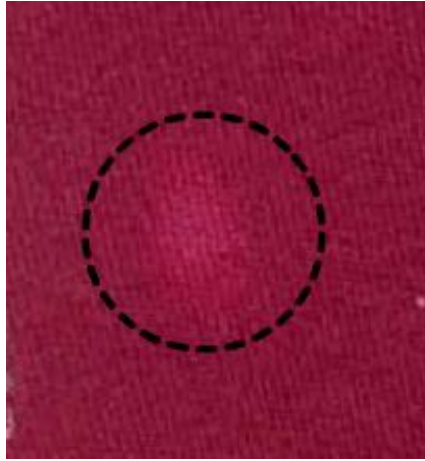
Resim 2.2: Su lekesinin kumaş yüzeyindeki görünümü
