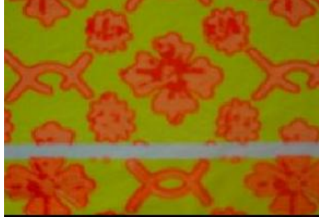
Resim 2.5: Desen kaymasının kumaş yüzeyindeki görünümü
