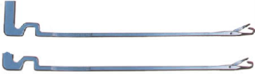
Resim 1.19: Sağlam olan ve kırık olan iğne ayağı görünümü
