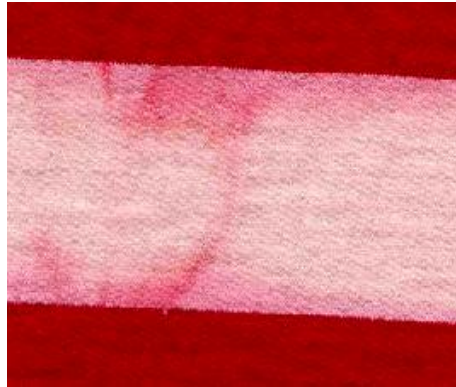
Resim 2.4: Boya akmasının kumaş yüzeyindeki görünümü
