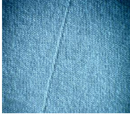
Resim 2.3: Kırık izinin kumaş yüzeyindeki görünümü
