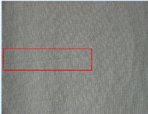
Resim 1.2: Kalın ipliğin kumaş yüzeyindeki görünümü ve ipliğe sarılmış lif uçuntusu
