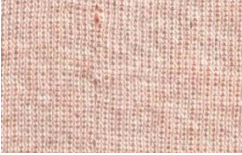
Resim 1.28: İğne delikleri hatasının kumaş yüzeyindeki görünümü
