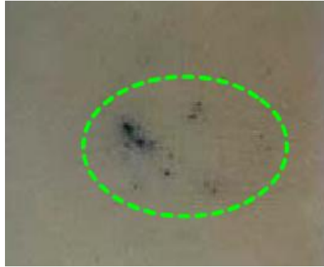
Resim 2.7: Boya lekesi hatasının kumaş yüzeyindeki görünümü
