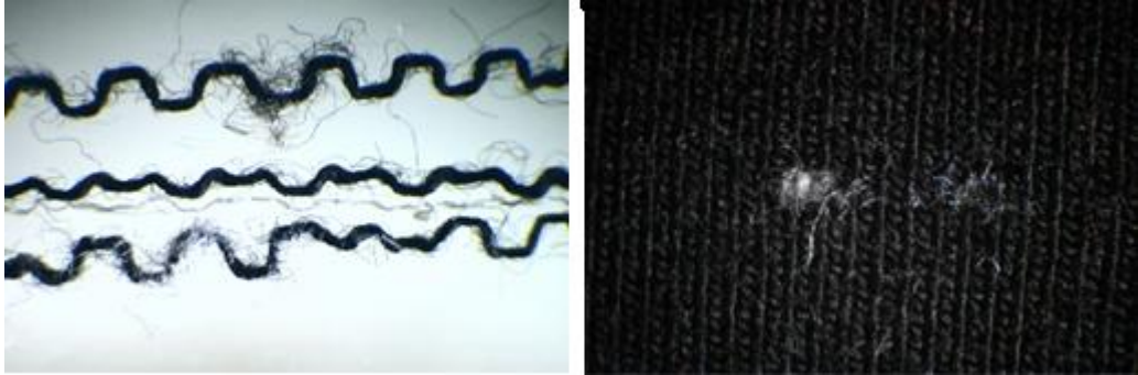
Resim 1.9: İplik üzerindeki uçuntu ve lif uçuntusunun yüzeydeki görünüşü
