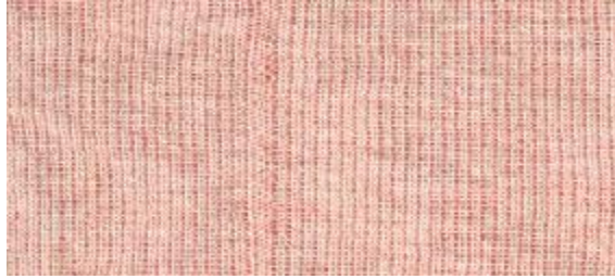
Resim 1.17: Kumaş yüzeyinde kanca eğilmesinden oluşmuş boyuna çizgi görünümü
