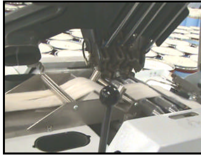
Resim 2.11: Cer makinesi çekim kısmına dublajlanmış bantların beslenmesi
