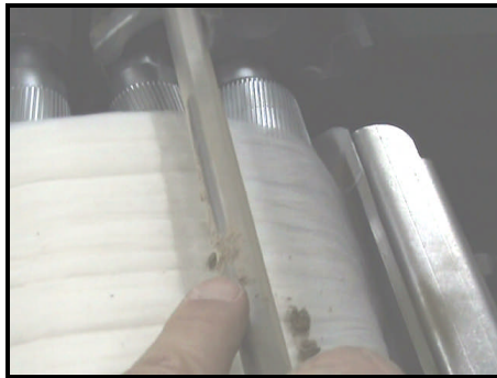
Resim 1.37: Baskı çubuğunun üzerinde birikmiş küçük partiküller (kısa elyaf kontrol çubuğu)
