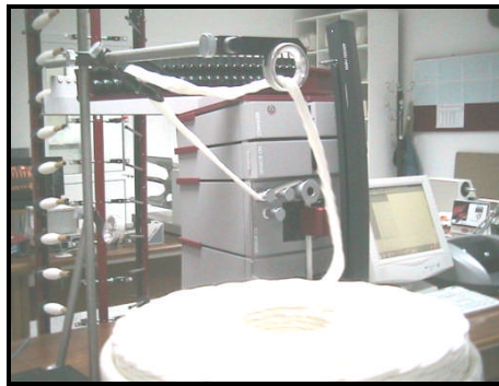
Resim 2.23: Cer numunesinin kova hâlinde laboratuvarında kalite değerlerine bakılması
