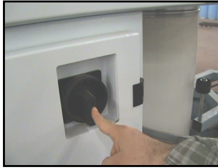
Resim 1.20: Bakım esnasında ana şalteri kilitlemesi
