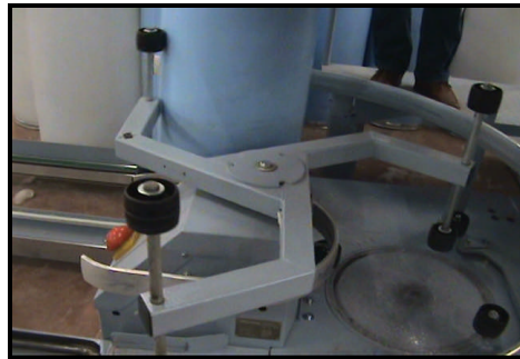
Resim 2.15: Raylı sistem ve otomatik kova değiştirme
